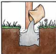
**2.** Der Spezialbeton muss nicht angemischt werden. Einfach das Material direkt aus dem Sack trocken, mit einer maximalen Schichtdicke von ca. 20 cm in das Erdreich geben.
