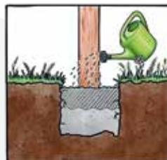
**3.** Bauteil ausrichten und dann den Spezialbeton mit erforderlicher Wassermenge begießen. Bei tieferen Aushüben müssen weitere Lagen in gleicher Weise und Stärke eingebracht werden. Am besten eine Gießkanne oder beim Schlauch eine Sprühdüse verwenden, damit das Wasser gleichmäßig auf den Spezialbeton aufgebracht wird.
