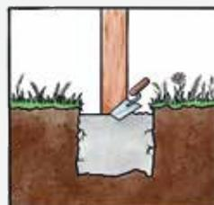
**4.** Durch anschließendes Stampfen und Stochern (mit Spaten oder Schaufel) muss dafür gesorgt werden, dass eine Verdichtung und gleichmäßige Durchfeuchtung des Spezialbetons sichergestellt ist. Die Oberfläche ist nach der Herstellung zu glätten. Die Erhärtung beginnt nach ca. 15 Minuten (abhängig von der Umgebungs- und Lufttemperatur).
