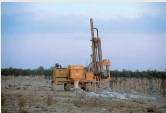
Die moderne Bohrmaschine zum Bohren der Sprenglöcher ist mit einer Entstaubungseinrichtung ausgerüstet.
