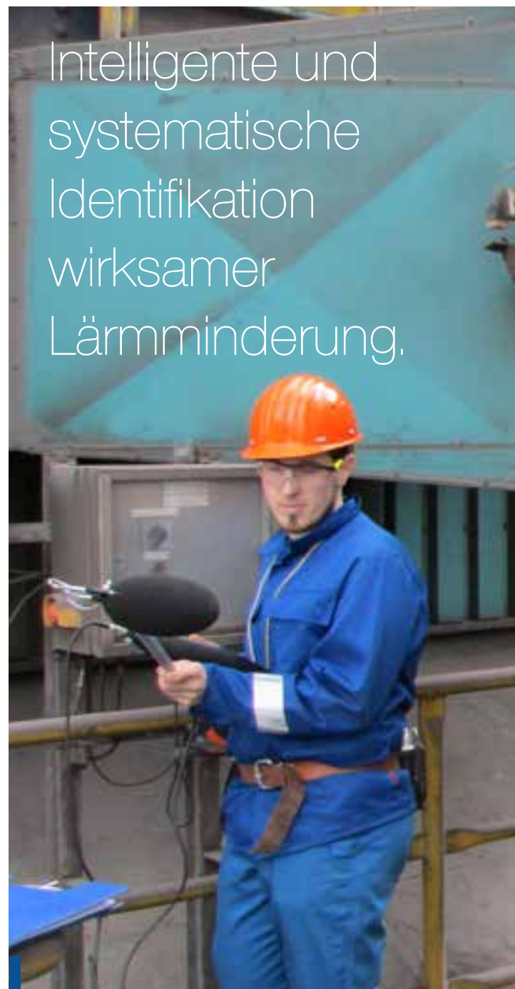
Mittels Schallpegelanalysator wird der von Anlagen und Gebäudeöffnungen ausgehende Lärm gemessen.
