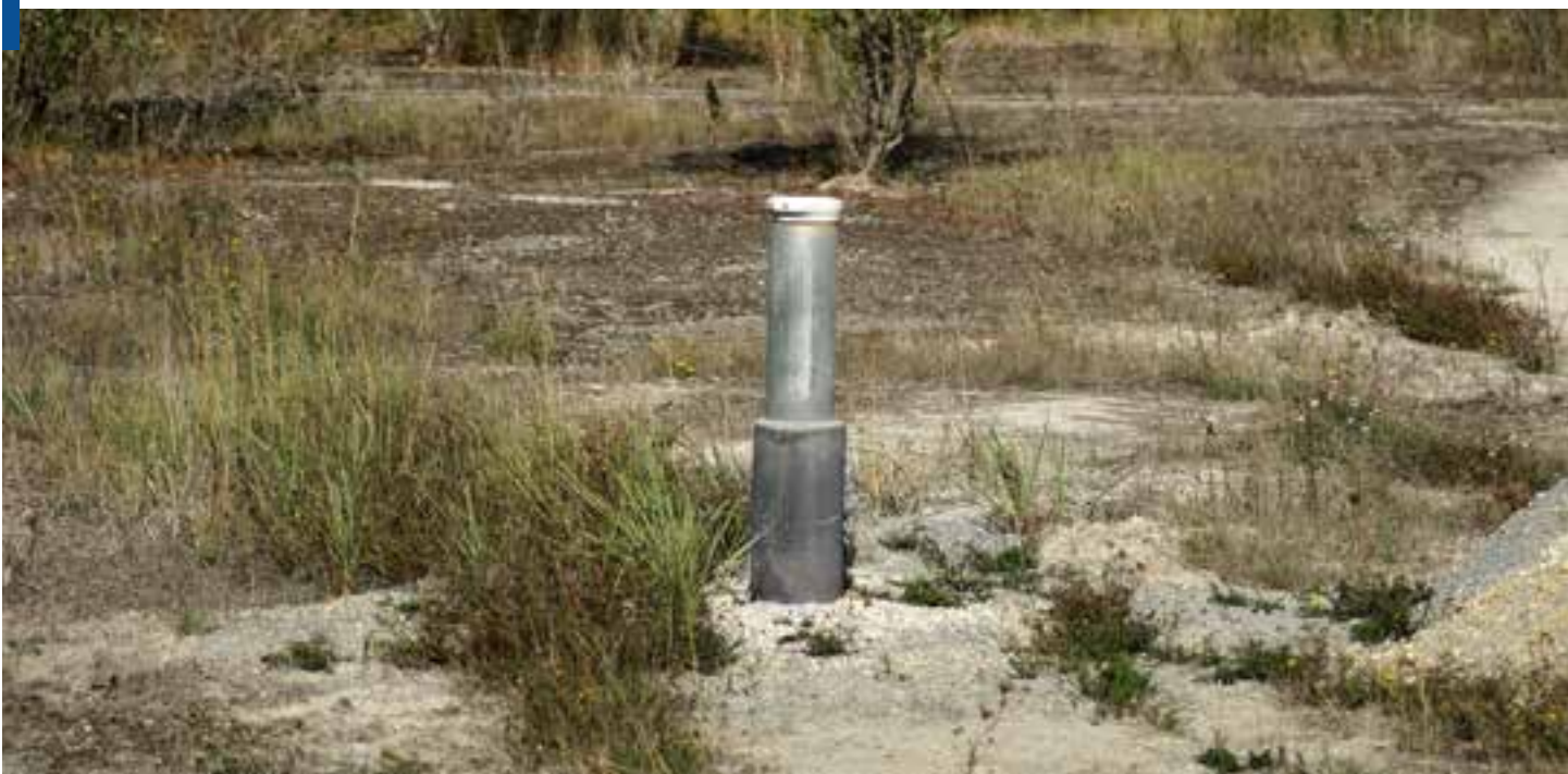
Grundwassermessstelle im Steinbruch Erwitte
