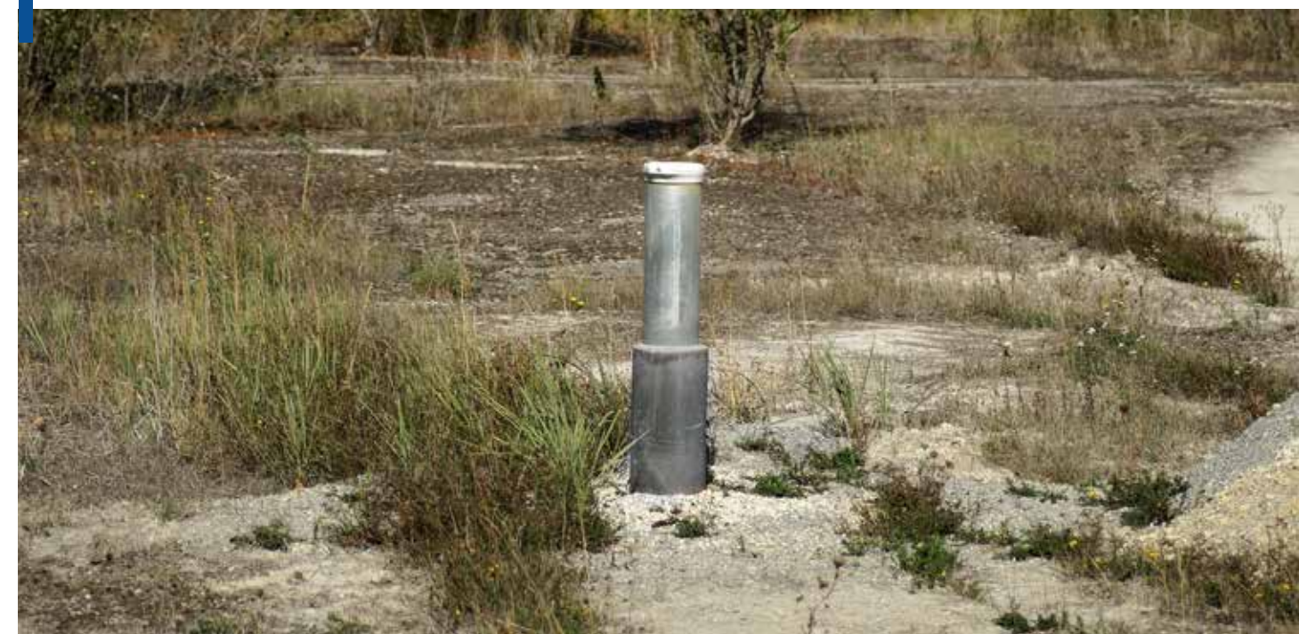
Grundwassermessstelle im Steinbruch Erwitte
