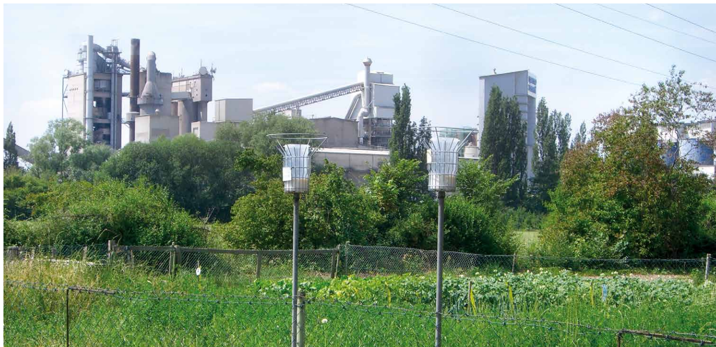
Messstelle in Erwitte zur Erfassung des Staubbiederschlags nach dem Bergerhoff-Messverfahren
